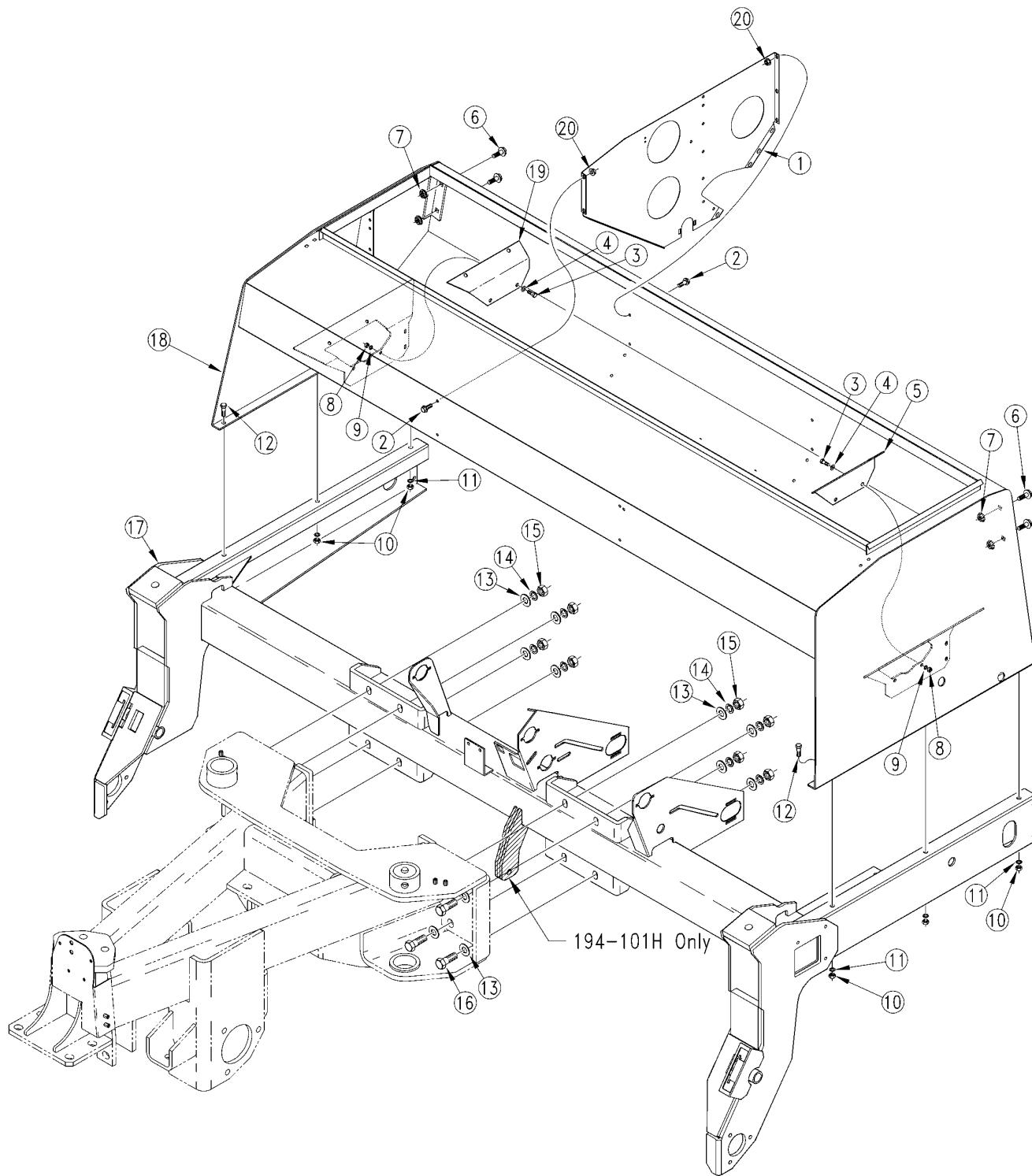
**Center Box And Center Frame To Mainframe**
