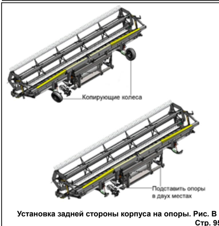
8. Включить двигатель комбайна, медленно опустить хедер на опоры. При касании режущего аппарата с опорами, проверить положение опор, убедиться в правильности расположения опор под режущим аппаратом и абсолютной горизонтальности положения опор, чтобы не допустить соскальзывания хедера с опор после размонтирования с комбайна.
