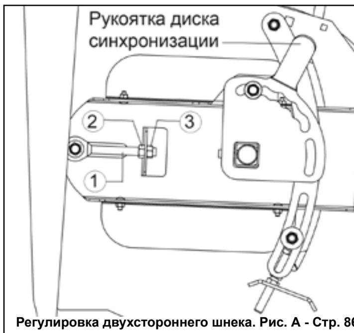
Для обеспечения правильной работы шнека с пальчиковым аппаратом, зазоры с обеих сторон шнека должны быть отрегулированы одинаково по всей длине шнека.
