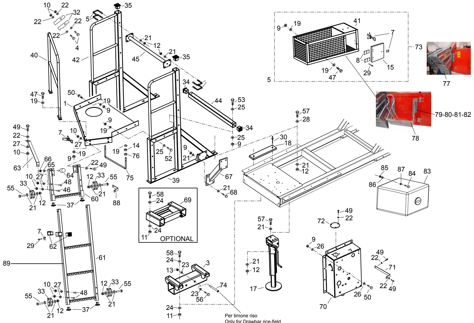
**Telaio postazione operatore Campo 22-32 / Frame emplacement operator Campo 22-32**
