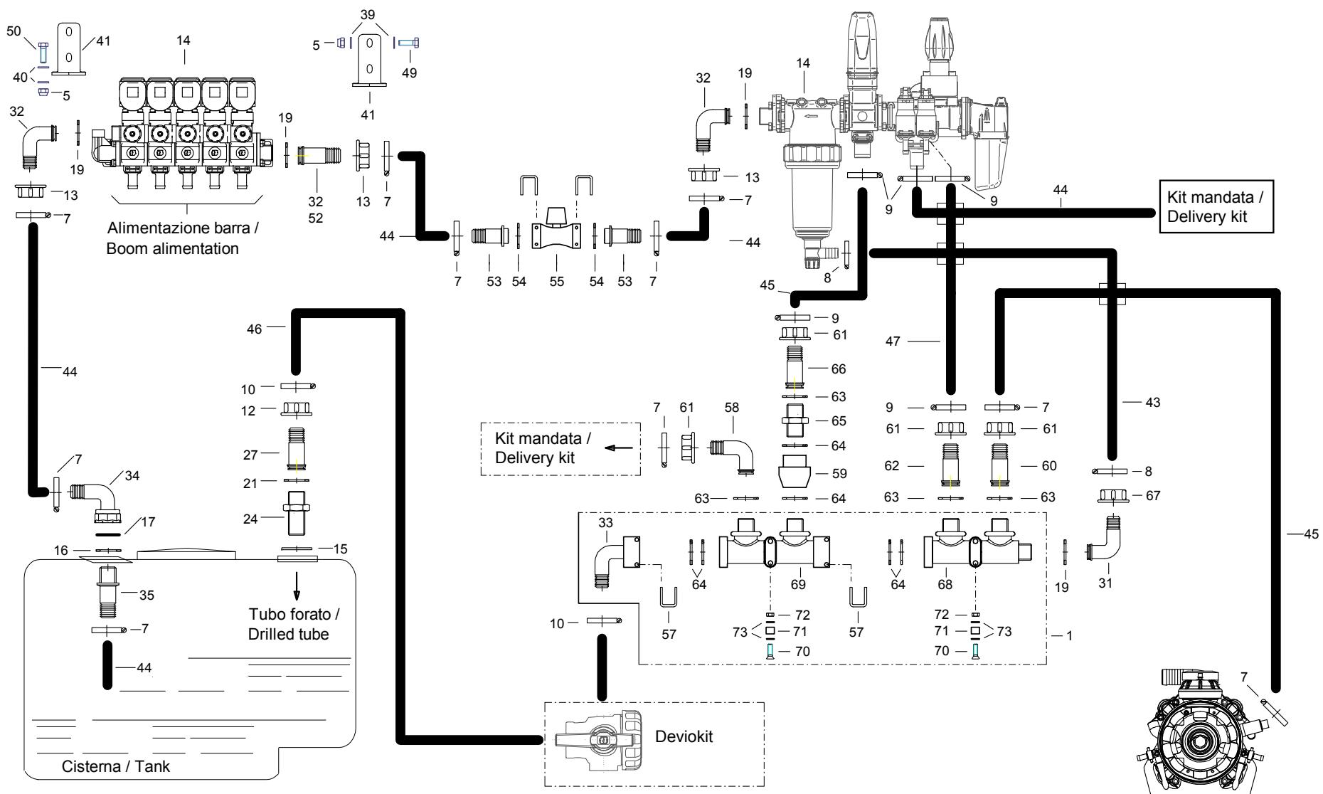
**Collettore scarichi + gruppo di comando OLD / Collector drain + control device OLD**
