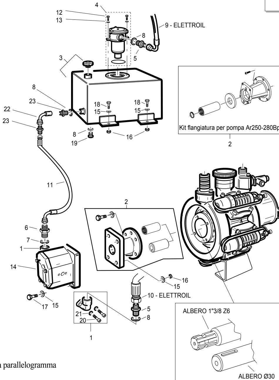
Pompa idraulica indipendente per / Independent hydraulic pump for:
