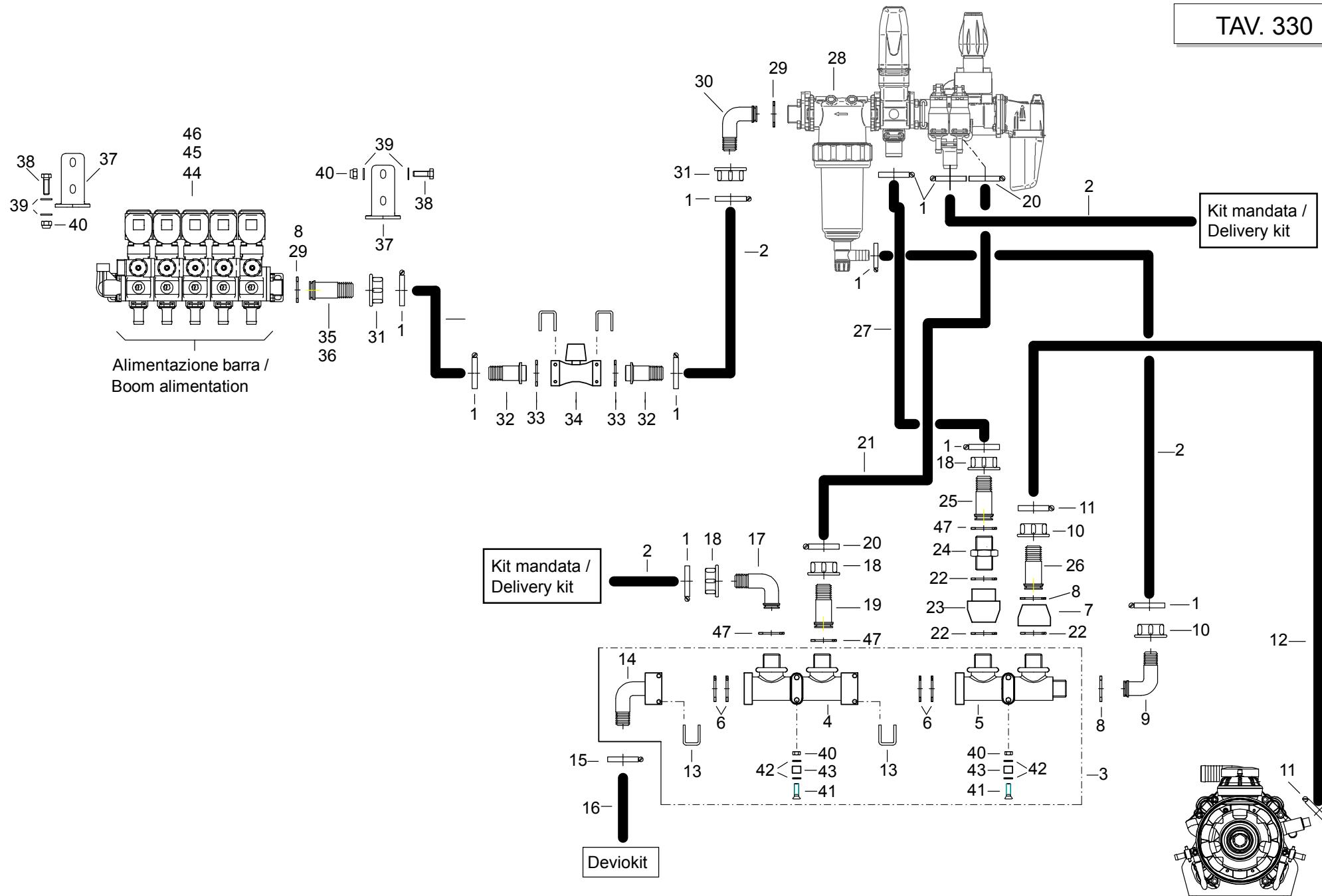
**Collettore scarichi + gruppo di comando / Collector drain + control device**
