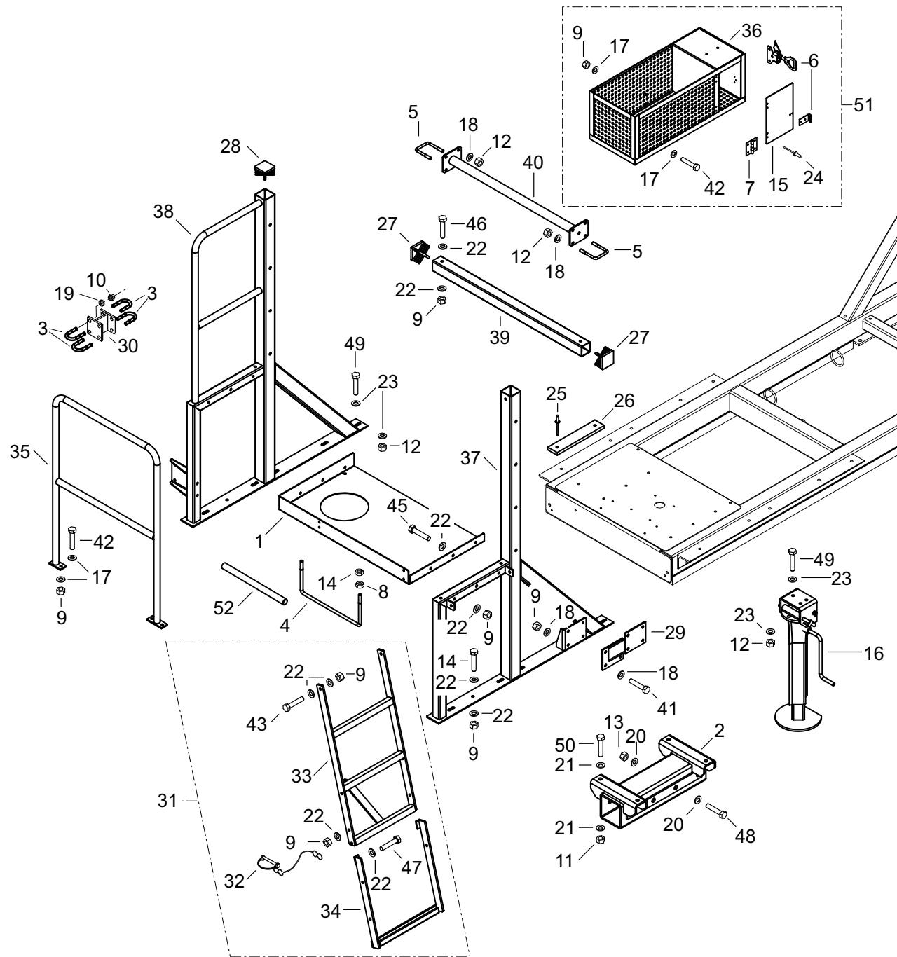
**Telaio postazione operatore Campo serie E-R / Frame emplacement operator Campo series E-R**
