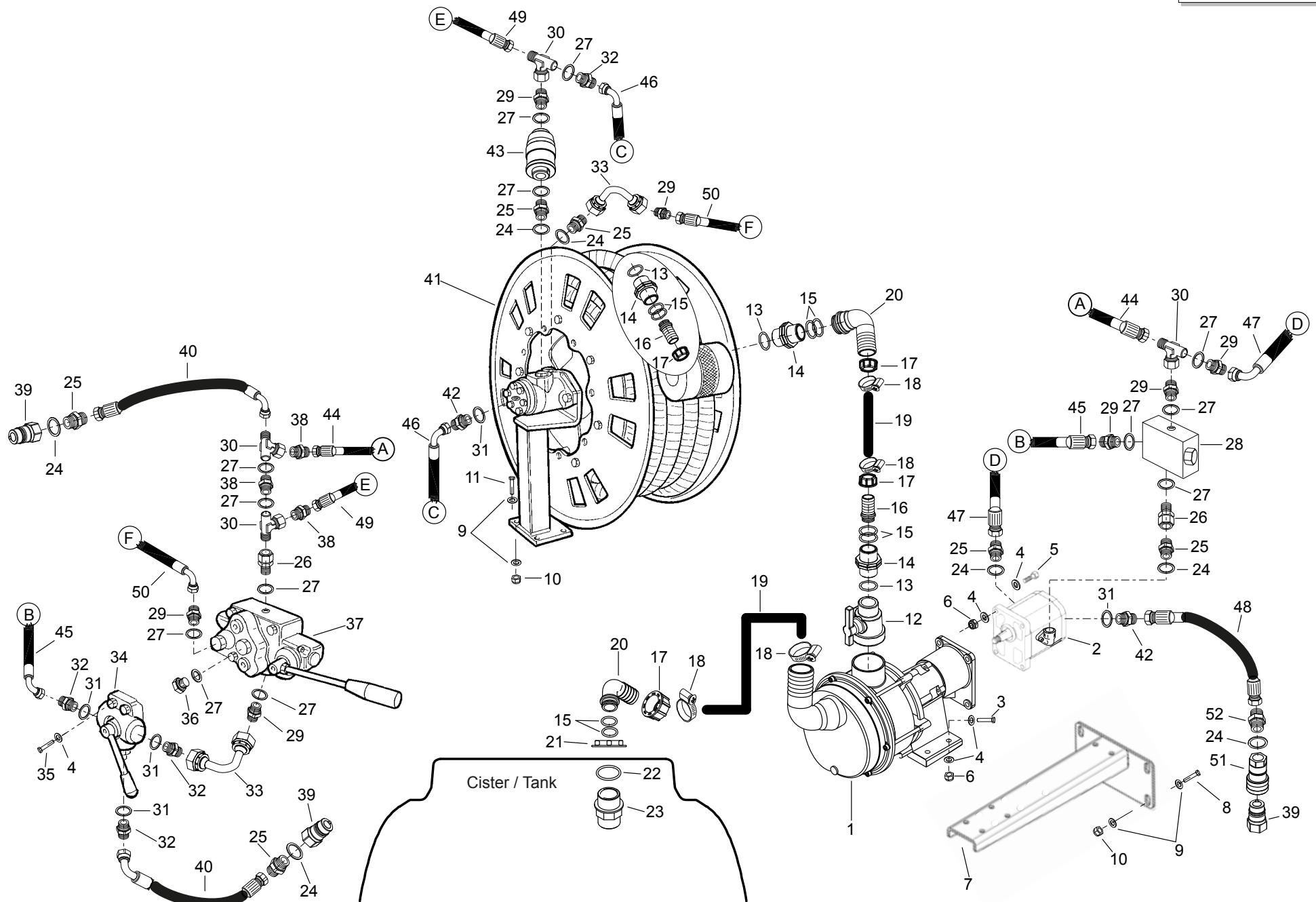
**Collegamenti pompa centrifuga + avvolgitubo idraulico / Connections centrifugal pump hydraulic hose reel**
