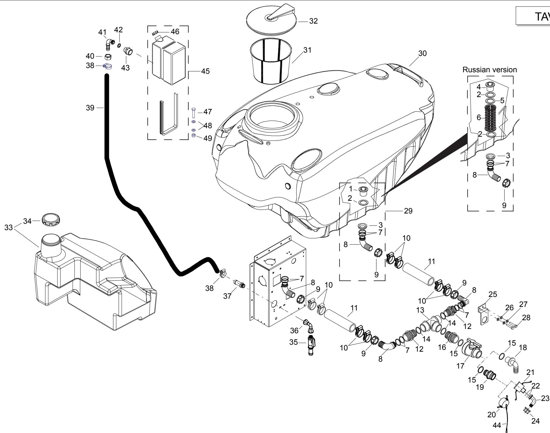
**Valvola di scarico + cisterna + lavamani / Drain valve + tank + handwashing**
